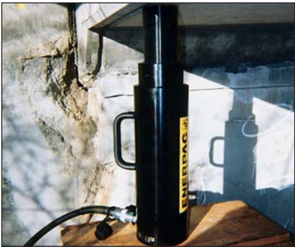
◀ 便携式螺母锁定油缸RACL-1506用于桥梁加固工程中的长时间负载支撑。
