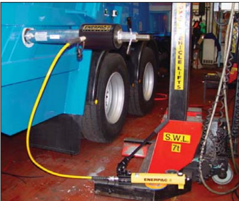
◀ 一个RACH-306油缸由P-392手动泵提供动力，将废品回收车车架上已被腐蚀的销子拔出。
