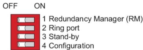
四个 DIP 开关中：第一个“RM”开关用于开启冗余管理器。第二个“Ring Port”开关位于“OFF”时，介质模块 1 的端口 1 和 2 做环端口使用，位于“ON”位置时，介质模块 2 的端口 1 和模块 2 的端口 2 做环端口使用。用户可以根据介质模块的端口类型分布来选择环端口。第三个“Stand By”端口是做“Network coupling”时使用。第四个“Configuration”开关是交换机设置优先级开关，当位于位于“ON”位置时，交换机是硬件设置优先，当位于位于“OFF”位置时，交换机是软件设置优先。我们推荐网络中所有的设备均通过软件配置，可将所有的开关拨到“OFF”位置即可。
